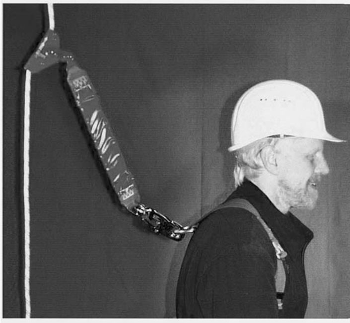
Bild 11: Mitlaufendes Auffanggerät an beweglicher Führung. Hier bildet der Falldämpfer das Verbindungsmittel zum Auffanggurt
