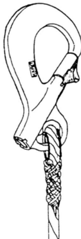
Bild 17: Karabinerhaken mit Einhandbetätigung, die Sicherung wird nach Drehen und Zurückschieben des Sperrbolzens geöffnet
