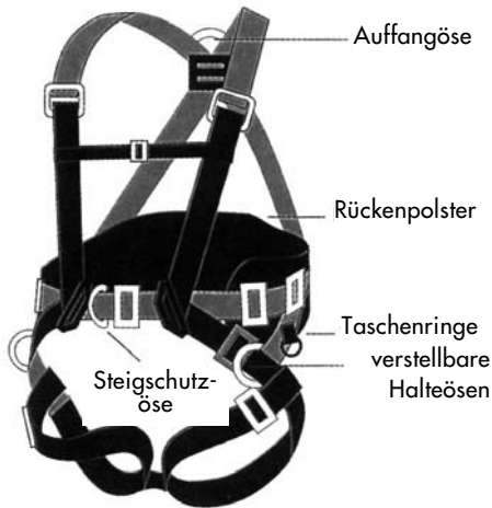
Bild 10: Auffanggurt mit rückseitiger Fangöse, zwei seitlichen Halteösen und einer vorderen Steigschutzöse; Rückenstütze bzw. Rückenpolster ist vorhanden
