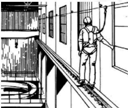
Bild 14: Anschlageinrichtung mit horizontalem Führungsseil
