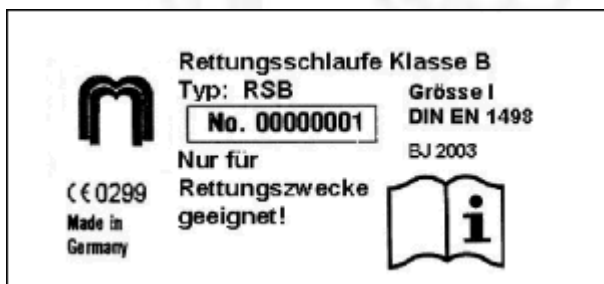
Bild 21: Muster der Kennzeichnung einer Rettungsschleufe
